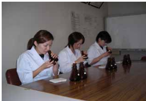
写2 . 臭気指数測定風景(排水試料)
