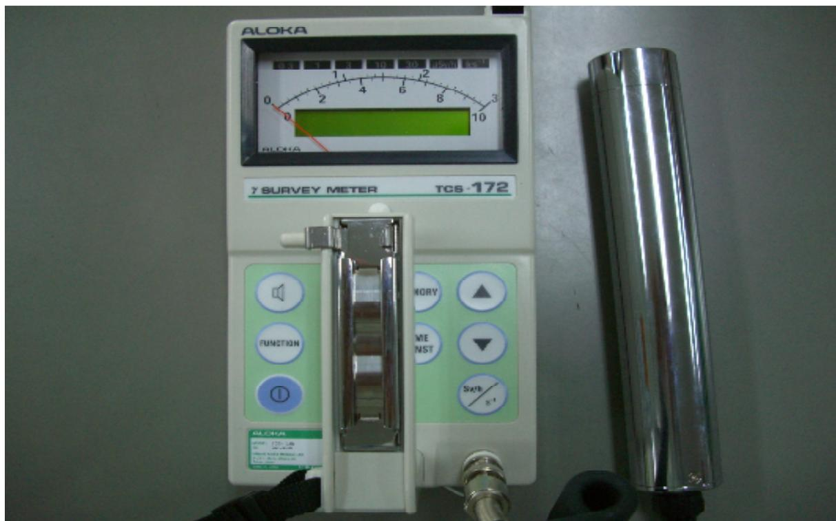
○フィルタチャンバーの表面における放射線量測定
