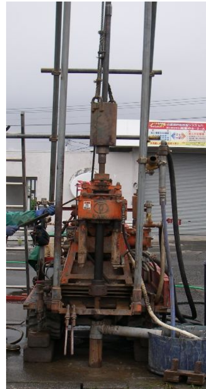
ボーリングによる試料採取
