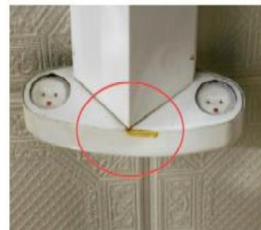
蛍光灯安定器の劣化により蛍光灯機器から PCB 油が漏れ出した例
