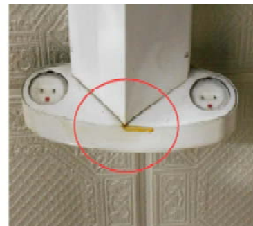
蛍光灯安定器の劣化により蛍光灯機器から PCB 油が漏れ出した例
