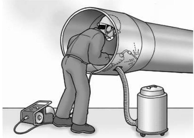
② 金属アーク溶接等作業を継続して行う屋内作業場について、金属アーク溶接等作業を新たに採用し、又は変更（溶接方法の変更、溶接ヒューム濃度に大きな影響を与える溶接材料、作業場所の変更）するときに、個人サンプリングによる空気中の溶接ヒューム濃度を測定する。
