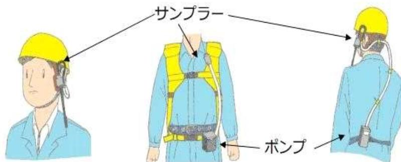
試料採取機器（サンプラー）は**呼吸域**に、採取口が**溶接面の面体内側**になるように装着します。
